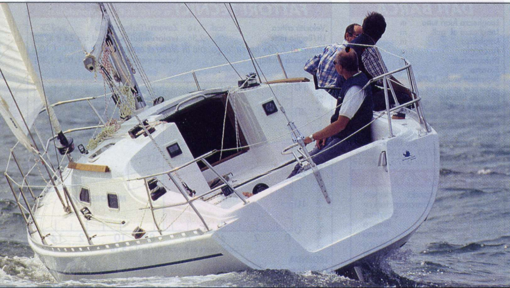
A differenza dei concorrenti più diretti, che mostrano sezioni di poppa larghe quanto il baglio massimo, l'Hurricane 315 ha volumi di carena più pieni a centro barca e uscite molto avviate.
